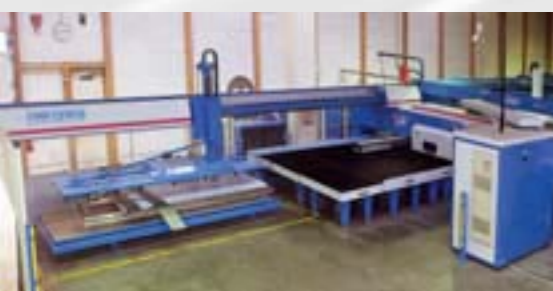
Die Stanz/Laser-Kombi beschleunigt seit einigen Monaten bereits die Herstellung der Edelstahl-Oberplatten.
