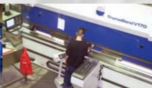
Auf der Trumabend werden die Mantel- sowie die Wandbleche der Unterbaugruppen präzise gebogen.
